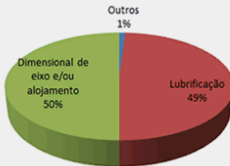
Falhas prematuras em rolamentos
